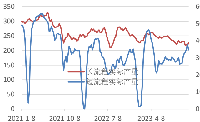
图 29: 长短流程产量走势图
